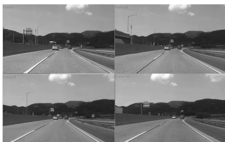
图9 视频帧序列车道线检测结果图
